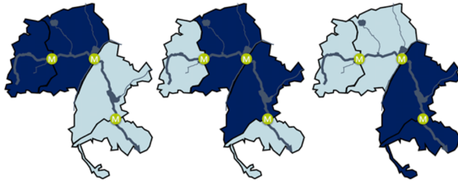
Figur 7. Kapacitetsplan 2018 er opstillet ved brug af tre designregn svarende til en 100-års regnhændelse, hvor det i praksis ikke regner lige meget i hele oplandet.
