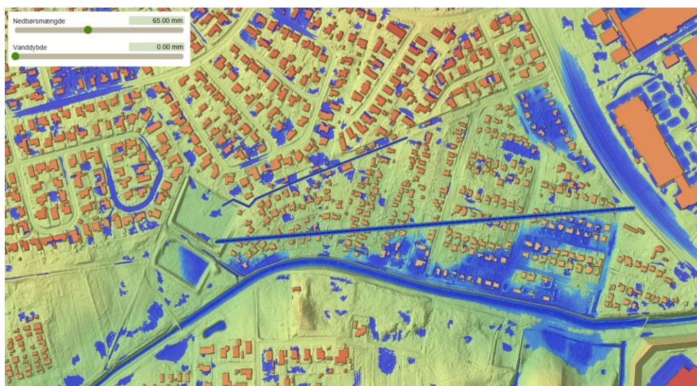
Figur 17: Det ses, at afstrømmende vand på terræn fører til oversvømmelse i lokale lavninger både opstrøms og nedstrøms den grøft, der simulerer afvanding af området. En løsning, hvor en pumpe ved diget pumper vandet ud i oversvømmelsesarealet vil fjerne en væsentlig del af oversvømmelsen langs diget, men der vil fortsat være behov for at beskytte de ejendomme, der er placeret i lokale lavninger.
