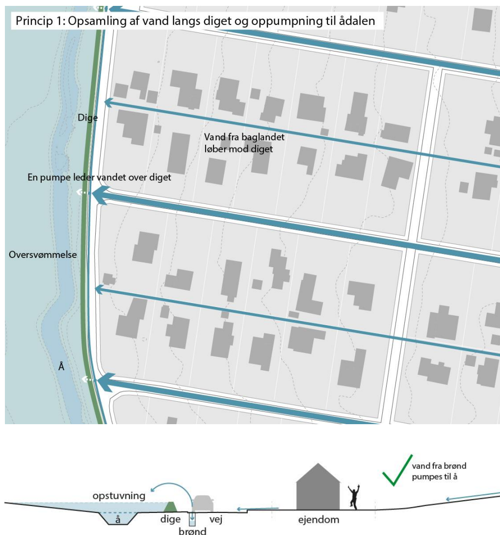
Figur 4: Princip 1 viser, hvordan bagvand kan opsamles, f.eks. langs diget, og pumpes ind i oversvømmelsesarealet i ådalen.
