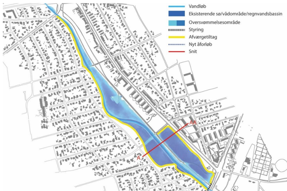
Figur 33: Vigerslevparken 3 er et eksempel på et område, hvor det er nødvendigt at afgrænse den planlagte oversvømmelse langs Harrestrup Å med et dige for at beskytte lavtliggende huse mod oversvømmelse fra ådalen. Diget vil lokalt forhindre afstrømmende vand på terræn og opstuvende vand fra afløbssystemet i at løbe ud i ådalen. Derved opstår en risiko for, at den ånære bebyggelse bag diget oversvømmes af bagvand fra det bagved liggende (opstrøms) opland.
