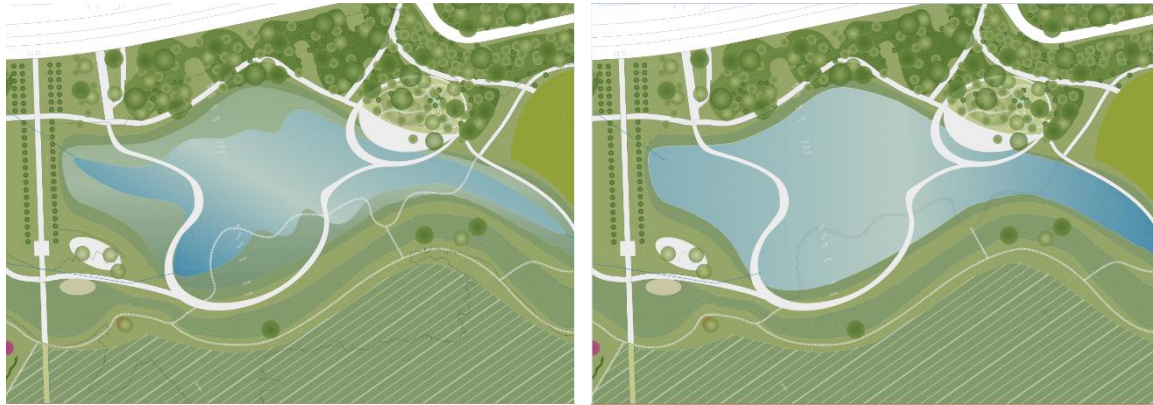
Figur 18. Eksempel på bassin med flade brinker. De flade brinker tilgodeser paddearter. Til venstre ses bassinet med det daglige vandspejl. Til højre ses det fyldte bassin efter en hverdagsregn hændelse. Der er planlagt forskellige stier, hvoraf nogle vil holde sig tørre ved hverdagsregn, mens andre ligger tættere på det daglige vandspejl, så de oversvømmes selv ved hverdagsregn.
