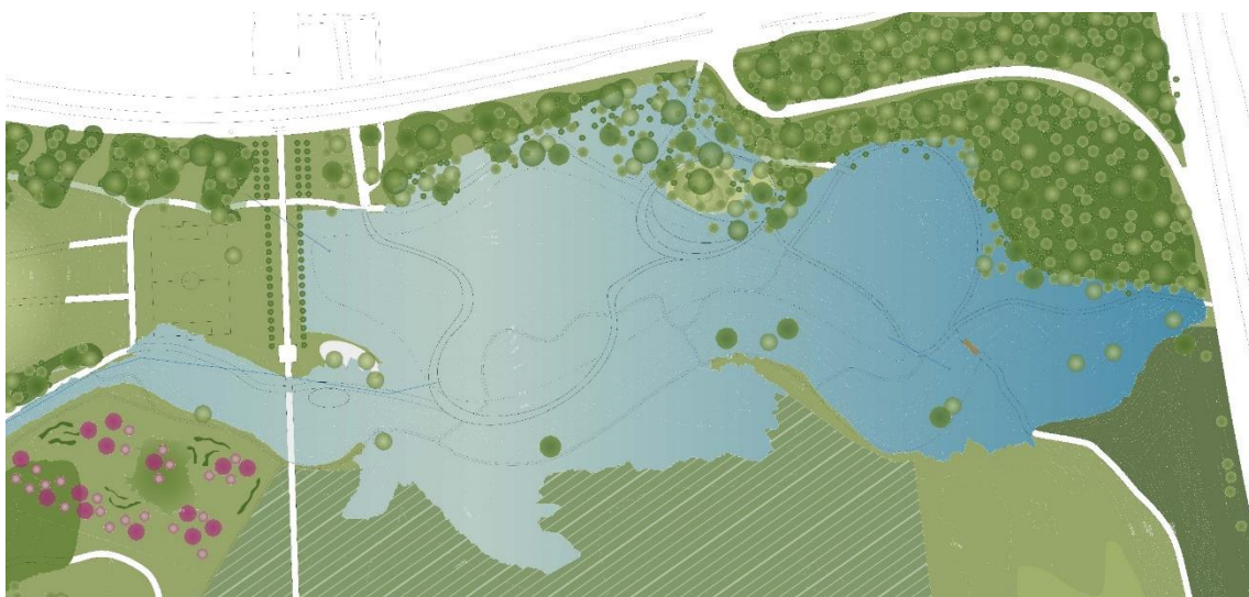
Figur 12: Ovenstående figurer er en grafisk fremstilling af hvorledes et bassin kan udformes til både håndtering af hverdagsregn og skybrud. I eksemplet her oversvømmer både skybrudsvolumenet og åen. I andre tilfælde kan skybrudsbassinet udformes, så det ikke har direkte kontakt til åen, men derimod forsinker skybrudsvandet til åen.
