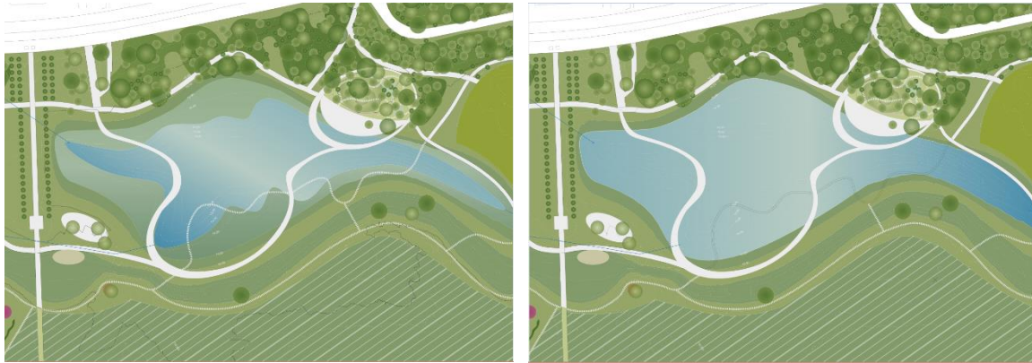
Figur 18. Eksempel på bassin med flade brinker. De flade brinker tilgodeser padderter. Til venstre ses bassinet med det daglige vandspejl. Til højre ses det fyldte bassin efter en hverdagsregn hændelse. Der er planlagt forskellige stier, hvoraf nogle vil holde sig tørre ved hverdagsregn, mens andre ligger tættere på det daglige vandspejl, så de oversvømmes selv ved hverdagsregn.
